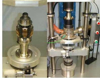
Anwendersversuche des neuen TE 47 6-Station Kolbenring/Zylinder Tribometers laufen z.Z..
