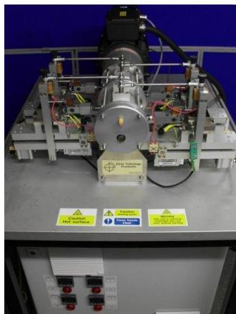
最初我们设计了两款往复试验机，一种是冲程为1mm的4工位摩擦试验机，另一种是冲程10mm的双工位的摩擦试验机。它们都可测量负载，摩擦行程和接触电势。经验告诉我们，客户对于往复试验机都有各自不同的需求。去年底，我们设计了一台10mm冲程四工位的试验机，除了摩擦力以外，可测量其他所有参数。然而，很难将所有的技术参数列在一个统一的设备资料中，因此我们提供定制。
