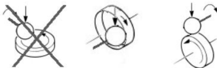
我们和清华大学摩擦学国家重点实验室合作设计一台新型的光学油膜厚度测试仪。经过双方的论证，我们决定放弃传统的球盘式，采用球环式的设计方案，以避免在接触时的旋转、倾斜及接触面乏油等问题。另外，这种设计还可以进行线接触和点接触下的膜厚测试。最后，在清华大学的建议下，未来该试验机还可用做经典的双辊试验机。
