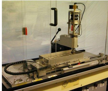
Nous avons construit une machine grande course, petite vitesse à mouvements linéaires alternés pour faire des essais avec des éprouvettes standards ou de large surface de contact, à sec ou lubrifiés. Le système de chargement et de mesure du frottement est basé sur le TE67 et le système de déplacement sur le TE69.
