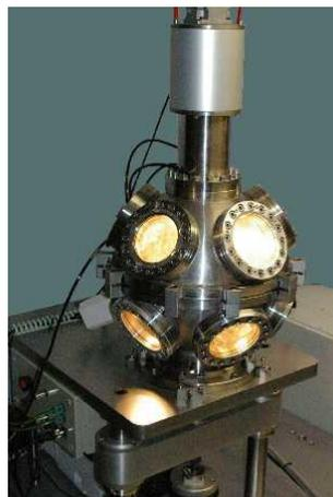
Le second tribomètre TE 91 a été livré avec un outillage permettant des essais de type « spiral orbit » comme stipulé dans la norme ASTM F2661.
