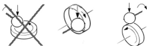
Nous continuons en partenariat avec « State Key Laboratory of Tribology » de l'université de Tsinghua, le développement d'un banc d'essai elasto-hydrodynamique optique. Après plusieurs discussions nous avons décidé de ne pas utiliser la configuration bille sur disque conventionnelle et d'utiliser une configuration
