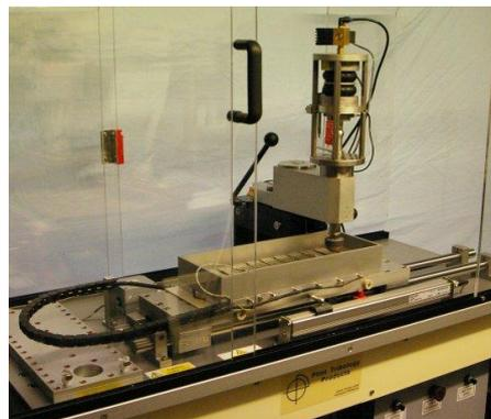
Wir haben ein Reib-Schwing-Verschleiss-Tribometer mit Langhub & niedriger Geschwindigkeit zur Untersuchung von Standard- und Großflächenkontaktproben bei Trocken- & Nassgleiten geliefert. Das Last- und Reibmeßsystem beruht auf dem TE.67 Prüfkopf und der Antriebsmechanismus auf dem TE.69 Linearantrieb.
