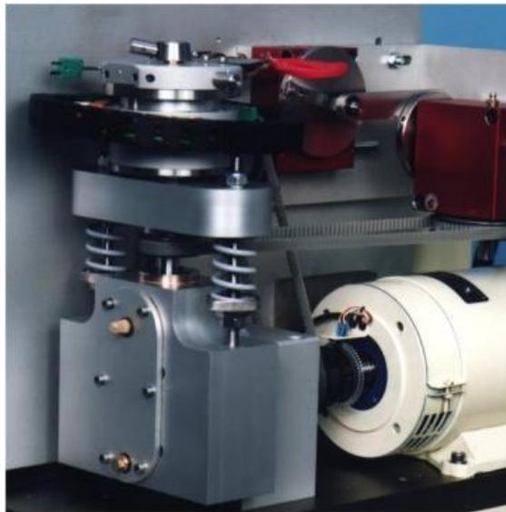
Der Kolbenring-Microwelding Adapter war bisher Zubehör der TE 77 Schwing-Reib-Verschleiß Anlage. Diese Anordnung war hier nur als Antriebskraft eingesetzt. Wir haben uns daher entschlossen den Microwelding-Adapter zukünftig als selbstständige Anlage anzubieten.
