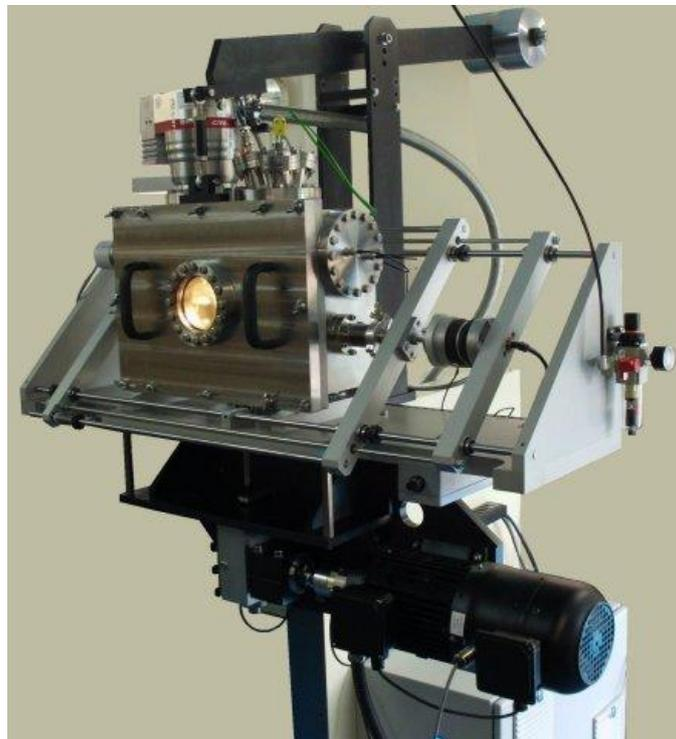
Das erste Zweiplatz Schwing-UHV Tribometer ist z.Z. In Produktion.
