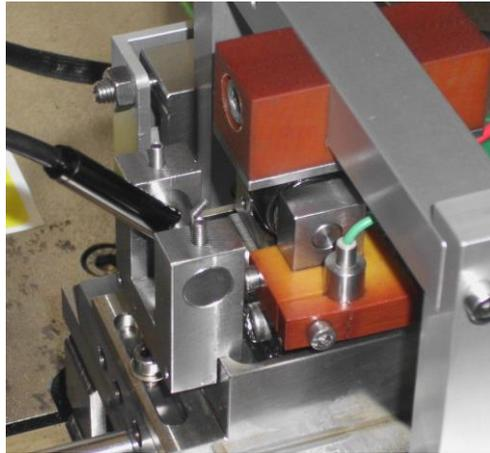
Nous avons fait des essais en utilisant une caméra endoscopique pour observer l'évolution de l'usure au cours de l'essai. Pour fonctionner il faut évidemment que la course soit assez longue pour exposer la cicatrice d'usure.
