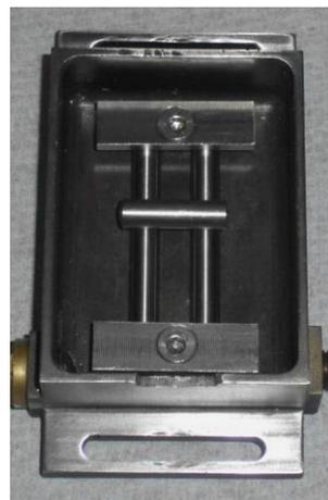
Nous avons modifié une étuve de TE 77 pour permettre de réaliser des essais pion sur bi-pions, comme ceux développés par Peter Blau à ORNL. Plus de détails sur cette configuration, particulièrement pour des essais de revêtements DLC sont disponibles dans notre section [essais de démonstrations](#).
