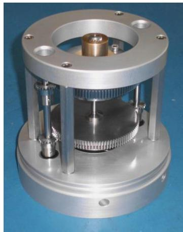
Nous avons construit un prototype pour tester une paire d'engrenages montés dos à dos. Cet adaptateur peut être utilisé sur notre *Tribomètre rotatif TE 92* tribomètre rotatif TE 92 ou sur le *Tribomètre sous vide TE 91*. Une vis sans fin hélicoïdale est utilisée pour transmettre la charge normale en couple sur les engrenages, permettant ainsi la régulation du couple transmis dans les engrenages durant leur rotation
