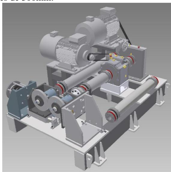
La plage de vitesse est de 1780 tr/min (une vitesse linéaire de 100km/h), le banc fonctionne avec un rapport de glissement fixe imposé par un réducteur de vitesse. Différents réducteurs de vitesse permettent des rapports de 100 :100 à 100 :90.
