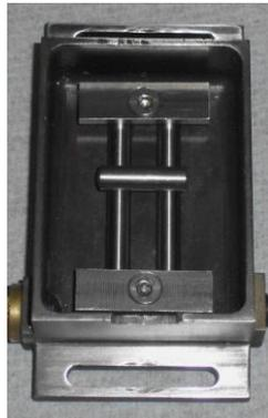
Wir haben erste Versuche mit der Geometrie ‚Stift-auf-Doppelstab‘ unternommen wie von Peter Blau am ORNL entwickelt. Einbau der Doppelstabproben wird erreicht durch Spanen von zwei Rillen im unteren Bereich des festeingebautem Standard-Versuchsbades zusammen mit einem Paar einfacher Zwingen. Weitere Informationen hierzu, speziell für DLC Untersuchungen, unter [Demonstrationsversuche](#).
