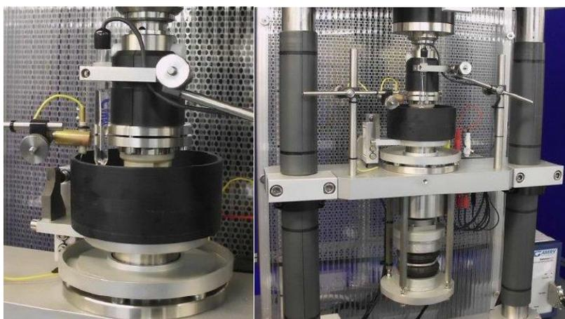
我们现在已经生产出了一个三销（或球）盘电化学电池，适用于结合参考 Gamry 600™ 稳压器/恒流器/ZRA, 使用在 TE92 旋转试验机上。
