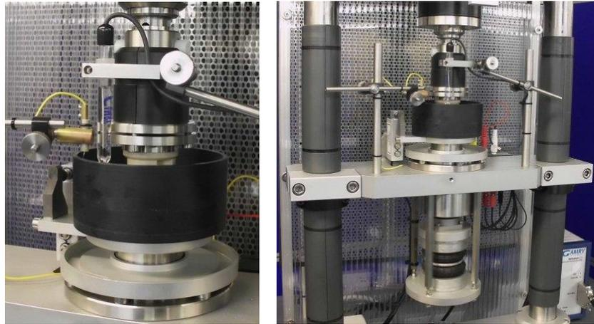
Nous avons conçu une cellule électrochimique pour essais rotatif avec trois pions (ou billes) sur disque, cette cellule est utilisée sur notre tribomètre TE 92 en conjonction avec le potentiostat/galvanostat Reference 600<sup>TM</sup> de chez Gamry.
