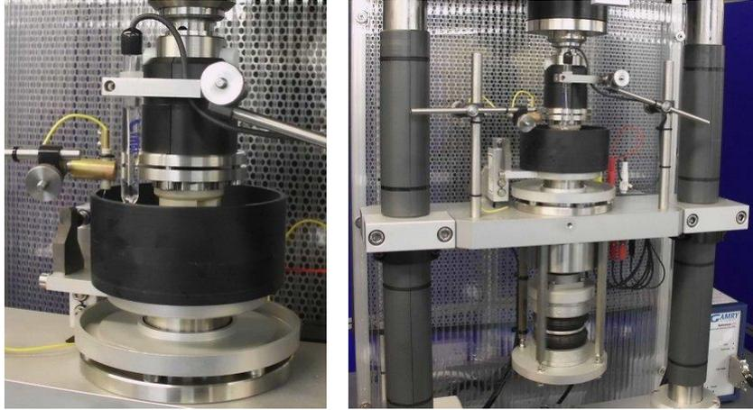
Wir haben nun für das TE.92 Rotationstribometer ein galvanisches Element mit drei (3) Umlaufstiften (oder –kugel) für Einsatz mit einem Gamry Referenz 600 TM Potentiostat/Galvanostat ZRA gefertigt.
