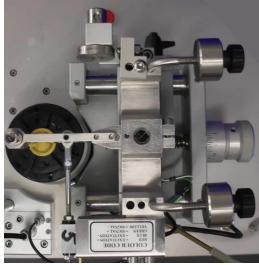
Le bras de mesure des frottements original était trop endommagé, nous avons donc due le refaire en ajoutant un pivot a lames flexibles et une gauge de contrainte.
