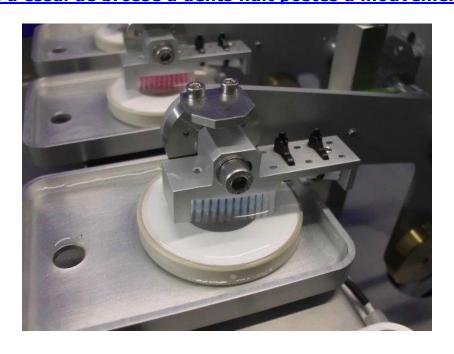
Nous avons utilisé le double mécanisme bielle/manivelle du <u>TE 87 Machine pion sur disque à mouvement orbital</u> pour transmettre un mouvement orbital à une plaque du banc d'essai de brosse à dents. Des capteurs d'effort trois axes peuvent être montés sur chaque poste pour mesurer l'effort normale et les frottements.
