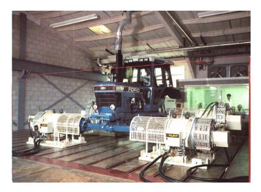
COMPEND, et ses interfaces associés, a été conçu pour être un système d'usage général de contrôle et d'acquisition de données. Au cours de son existence, il a été utilisé pour piloter de nombreux tribomètres, banc d'essai de moteur et banc de transmission.
