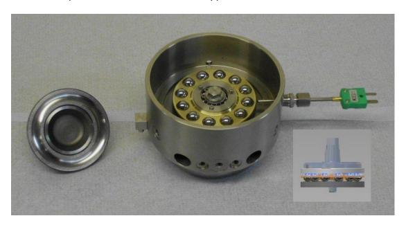
Contrairement aux essais ARKL, notre outillage utilise seulement un chemin de roulement 51208, le chemin inferieur étant remplacé par un disque et les billes maintenues par une cage spéciale. La rotation induite entre les billes et le disque provoque une rupture par fatigue.
