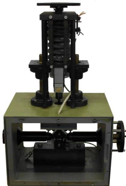
试验机腔体的内部附件包括一个固定样品组件，可用于安装带有加热功能的定时样组件。定时样安装了一个标准Kistler 三轴压电传感器，其中一个测量轴专用于测量摩擦力。加载系
