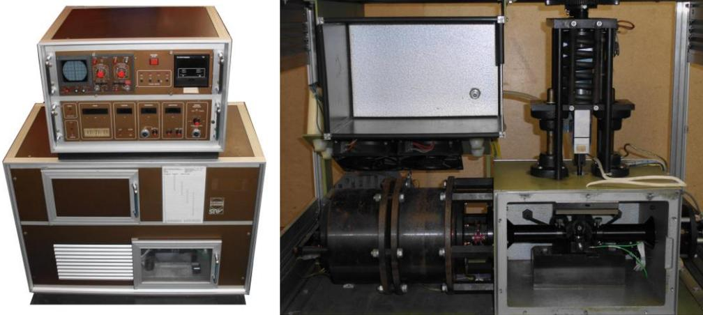
在升级的过程中，我们决定将不再继续使用原有的电磁驱动系统，或是换一个全新的但是价格昂贵而且又重的电磁驱动系统。我们选用的解决方案是用设计简单、低成本的固定行程的电机往复驱动来代替原驱动系统。
