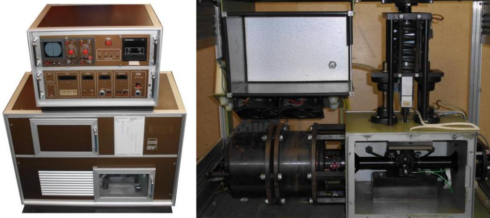
Nous avons décidé qu'il n'était pas logique d'essayer de réutiliser ou de remplacer le système de pilotage électromagnétique coûteux et très lourd et que la solution correcte était de le remplacer par un simple système à mouvements linéaires alternés piloté par moteur électrique, à faible coût et à course fixe.
