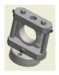
基于该问题的难度较□,我们现在使□完整的滑动轴承进□测试,轴承壳安装在标准连杆的部分切割件中,通过□加载侧和轴承壳之间的孔进□油润滑,从□保证薄膜润滑。
