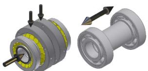
该试验机配有径向和轴向组合加载的测试组件,通过背靠背的设计,可配置安装四个相同的轴承。 可测试圆锥滚□,球□滚□,圆柱滚□,□接触和深沟球轴承。测试轴承内圈尺□40mm - 5mm,轴承外径最□140 mm。最□轴向载荷为16 KN,每个轴承的最□径向载荷为40 KN。
