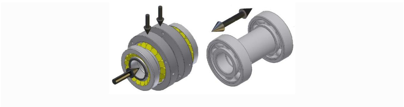
Nous avons terminé la conception d'un banc d'essais haute vitesse de fatigue et frottements de roulements, avec un outillage permettant des essais avec effort axial et radial ou un effort axial bidirectionnel.
