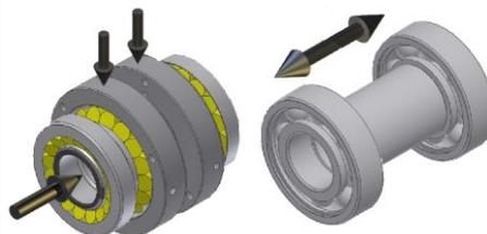
Wir haben Design und Fertigung einer Hochgeschwindigkeits-Lagerermüdungs- & Reib-Versuchsanlage abgeschlossen. Dieser Versuchsaufbau erlaubt zusammengesetzte Axial- und Radialbelastung wie auch bidirektionale Axialbelastung.
