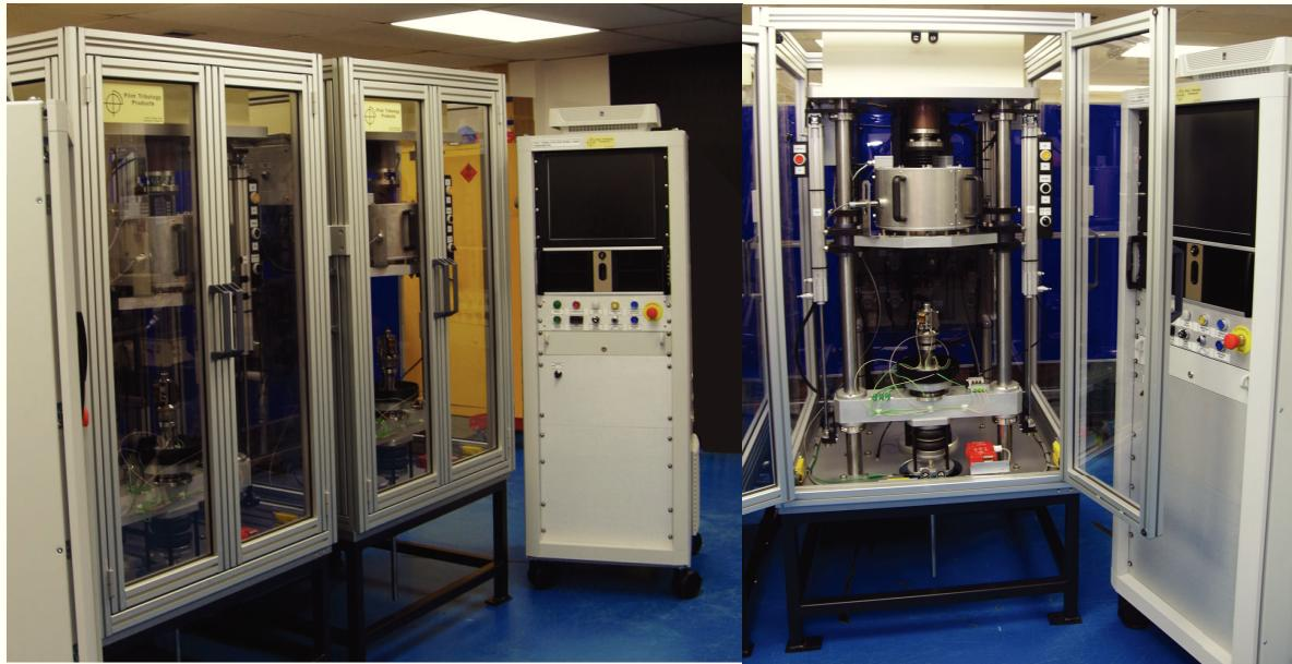
通过进一步合理化现有TE47机器的设计，我们最近完成了两个新设备的生产，客户是德国的两个汽车测试实验室。目前的设计，可以装配不同尺寸的工装，用于测试大型和小型的缸套。
