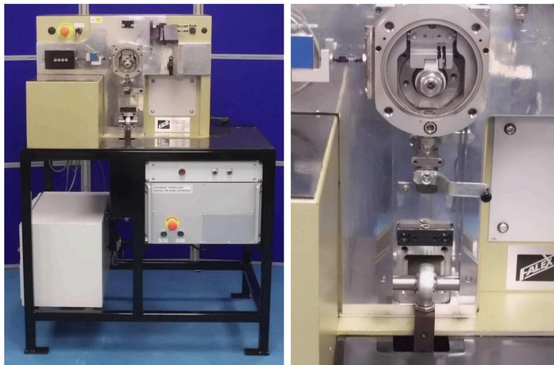
À ce jour, nous avons fourni plus de trente rétrofits de machine Falex bague plan basés sur COMPEND. Ces rétrofits comprennent un nouveau moteur, une interface électrique et interface informatique, mais aucun composant mécanique.
