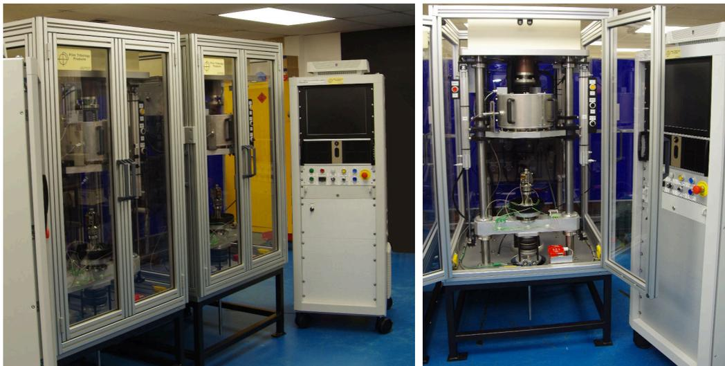
Après avoir rationalisé la conception de la machine TE 47, nous avons récemment produit de deux nouvelles unités pour deux laboratoires de services contractuels en Allemagne. Nous avons maintenant un concept permettant de tester différentes tailles/diamètres de cylindres en utilisant un outillage approprié.
