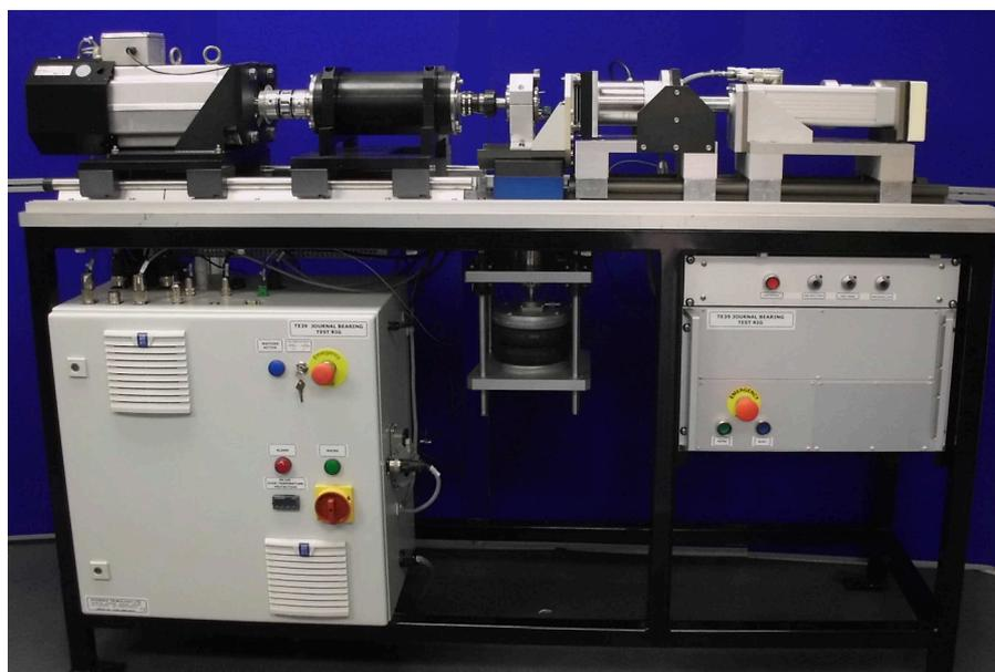
Nous avons terminé la conception et la fabrication d'un banc d'essai de frottement de palier lisse capable de rotation continue, d'oscillation axiale et de mouvement linéaire axial. Le roulement testé est monté sur un socle soutenu par un palier à air, un capteur bi axial de couple et de force permet de mesurer les forces de frottements linéaires induites par le déplacement axial ou le couple du mouvement de rotation.
