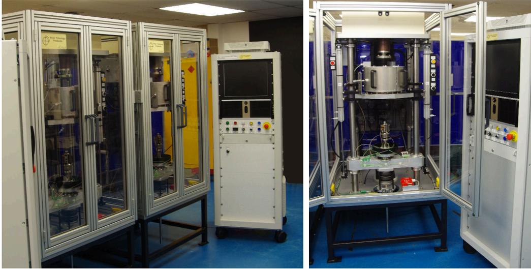
Nachdem wir das Design der TE.47 Anlage weiter rationalisiert haben, haben wir kürzlich die Lieferung von zwei Einheiten an zwei Auftragslabors in Deutschland abgeschlossen. Wir haben jetzt ein definierbares Design, mit dem mit geeigneten Werkzeugen sowohl kleine als auch große Liner getestet werden können.
