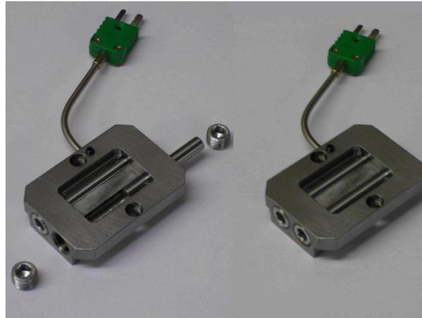
Wir haben das Angebot an Adaptern für das TE.77 um ein neues Pin-on-Twin Probenbad erweitert. In dem Bad sind 2 Teststäbe mit einem Durchmesser von 6 mm und einer Länge von 40 mm als 'Zwillingspaar' montiert.
