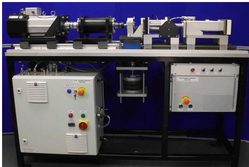
Wir haben die Entwicklung und Fertigung eines Gleitlager-Reibungsprüfstandes angeschlossen, der für kontinuierliche Rotation, Rotationsoszillation und Axialbewegung geeignet ist. Das zu prüfende Lager befindet sich in einer Halterung, die von einem Luftlager getragen wird, wobei die Axial- und Drehbewegung durch einen kombinierten Drehmoment- und Axialkraftwandler begrenzt wird.
