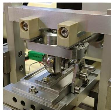
L'objectif initial de l'outillage était de modéliser le contact de glissement-roulement dans un joint homocinétique de trépied. Une courte vidéo sur ces essais peut être visionnée sur notre page LinkedIn. Veuillez cliquer sur le lien pour la visualiser [Tripod CV Joint Friction Test](#).
