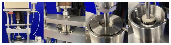
Wir haben jetzt erfolgreich eine standardmäßige Kugel-auf-Stab-Rollkontakt-Ermüdungsgeometrie auf einem TE.92HS Tribometer über längere Zeiträume bei 10,000 U/min durchgeführt.
