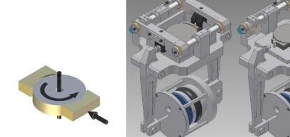
Bei einem Gleitlager liegt der Punkt des Spitzendrucks nicht auf der Mittellinie. Bei einer halben Gleitlagerkontaktfigur (einschließlich des konformen Blocks auf dem Ring) führt dies dazu, dass sich der Einlass schließt, wodurch verhindert wird, das Schmiermittel in den Lagerkontakt gelangt und eine Mangelschmierung verursacht. Konstrukteure von Teilgleitlagern gehen dieses Problem an, indem sie Lager mit der erforderlichen "Vorspannung" und "Versatz" konstruieren.
