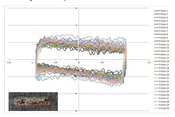
Bei diesem Kugel-auf-Flach Test betrug der Hub 2 mm und die Belastung 150 N.
