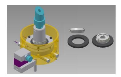
Wir haben die Entwicklung und Fertigung von Konus-auf-Elastomer-Werkzeuge für trockene und geschmierte Reibversuche von Metall-Polymer-Kontakten abgeschlossen.
