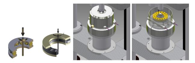
Seit einigen Jahren veröffentlichen Prof. Jorge Seabra und sein Team an der University of Porto Ergebnisse von Tests an einer modifizierten TE.92 Maschine mit auf einem Drehmomentaufnehmer montierter Wälzlagerprüfanordnung. Das neueste Paper scheint <u>Friction torque in grease lubricated thrust ball bearings</u> - T Cousseau, B Graca, A Campos, J Seabra - Tribology International 44(5):523-531 2021 zu sein.
