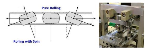
Der ursprüngliche Zweck des Adapters war es, den Gleit-Rollkontakt in einem Stativ-Gleichlaufgelenk zu modellieren. Ein kurzes Video zu diesem Experiment kann auf unserer Linkedin-Seite angesehen werden. Klicken Sie auf den Link Tripod CV Joint Friction Test, um dies zu sehen.
