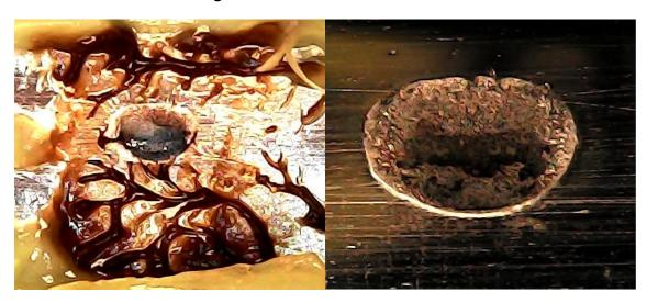
Unsere ersten Versuche wurden mit einer Kugelprobe durchgeführt, die in einer gekrümmten Nut lief. Dann entschieden wir uns, was passiert, wenn wir die Kugel gegen eine flache Oberfläche laufen lassen, was natürlich viel einfacher ist als ein gerilltes Exemplar.
