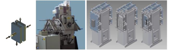
Wir schließen das Re-Design des TE.104 Prüfstands ab, verbessern die Wasserstoffsicherheit, erhöhen den Prüfdruck auf 5 bar, die Belastung auf 500 N und die Hubamplitude auf +/- 100 mm. Die maximale Frequenz bleibt 20 Hz
