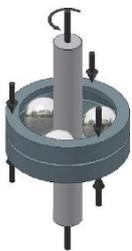
我们成功地在 TE 92HS 试验机上，以 10,000 rpm 的速度成功运行了三球/滚棒的长时滚动接触疲劳测试后，我们现在希望将 RCF 6 的最大速度提高到 20,000rpm。
