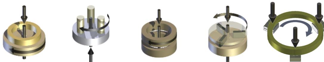
多年来，我们设计了很多个面接触的摩擦工装。我们曾经尝试给每个工装提供独立的测试池，还包含用于测量磨损位移的电容探头。在实际操作时，只有测试中能够产生足够多磨损的实验，工装所配套的磨损测量才有必要。因此，用电容探头是无法有效测量如聚合物等材料进行干滑动摩擦测试的磨损量。
