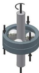
Après avoir exécuté avec succès des essais de fatigue par contact de roulement bille sur tige, sur un TE 92HS, à 10 000 tr/min, nous cherchons maintenant à augmenter la vitesse maximale à 20 000 tr/min sur notre RCF 6.
