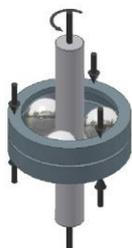
Nachdem wir auf einem TE.92HS mit 10,000 U/min eine Standard ‚Kugel-auf-Stab‘ Rollkontakt-Ermüdungstestgeometrie durchgeführt haben, versuchen wir nun, die Höchstgeschwindigkeit von RCF.6 auf 20,000 U/min zu erhöhen.
