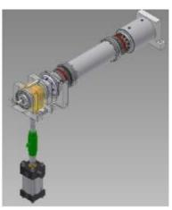
DN22 单工位滑动轴承试验机,其运动由半旋转伺服液压驱动产生,实现高载低速的滑动轴承摩擦磨损测试。
