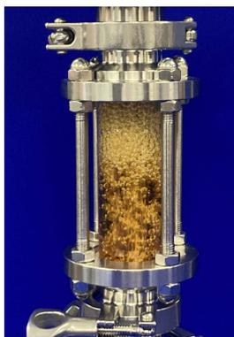
我们近期正在测试微型油预处理装置的原型机。该预处理反应器提供氮气环境，以避免产生爆炸性混合物。目前我们计划使用的气体包括 10%  $H_2$  - 90%  $N_2$  混合物、中低浓度的  $NO/N_2$ 混合物、中低浓度的  $NH_3/N_2$ 与热蒸汽的混合物。该装置后续将用在标准TE77长行程往复试验机上，进行润滑剂在特殊环境下的性能评定。
