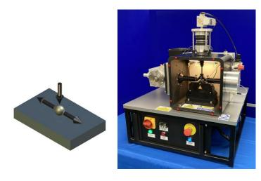
Mit dem mechanisch angetriebenen Schwing-Reib-Tribometer mit Kurzhub können Versuche mit Kugeln auf flachen Testgeometrien durchgeführt werden, wobei die in zahlreichen ASTM-Stardardtests festgelegten Verfahren eingehalten werden.
