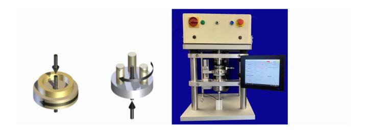
Diese Anlage ist für die Durchführung von Trockentests gemäß ASTM D3702 Anlaufscheibe und G99 in 3-Stift-auf-Scheibe-Testverfahren ausgelegt. Für Online-Verschleißmessung kann eine optionale Kapazitätssonde in die Testanordnung integriert werden.
