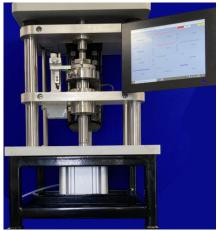
Diese Maschine verfügt über zwei Lastaktuaren, einer mit niedrigen Bereich für Vierkugeltests und der andere mit hohen Bereich für Vierkugel-EP-Tests. Ein Touchscreen-PC mit vorprogrammierten Testsequenzen ist vorhanden.
