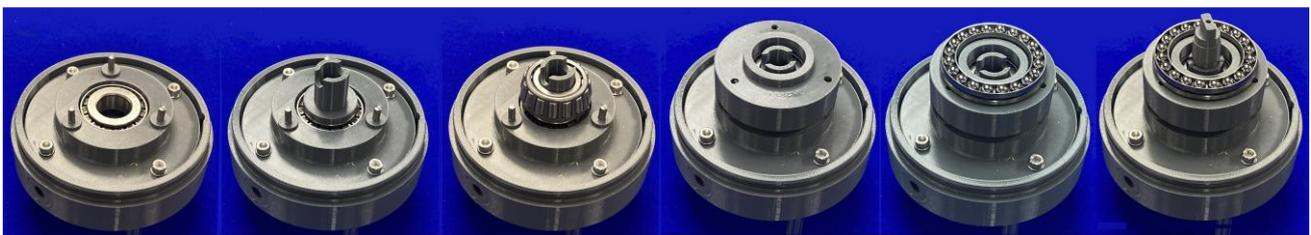
Der abgebildete Adapter zeigt Kegelrollenlager 30204. Die axial belastete, Rücken-an-Rücken-Testgeometrie mit einem zusätzlichen zweiten Axialkugellager bedeutet, dass das Versuchslager mit Belastungen betrieben werden kann, die die Kapazität der Spindel der Testmaschine überschreiten.
