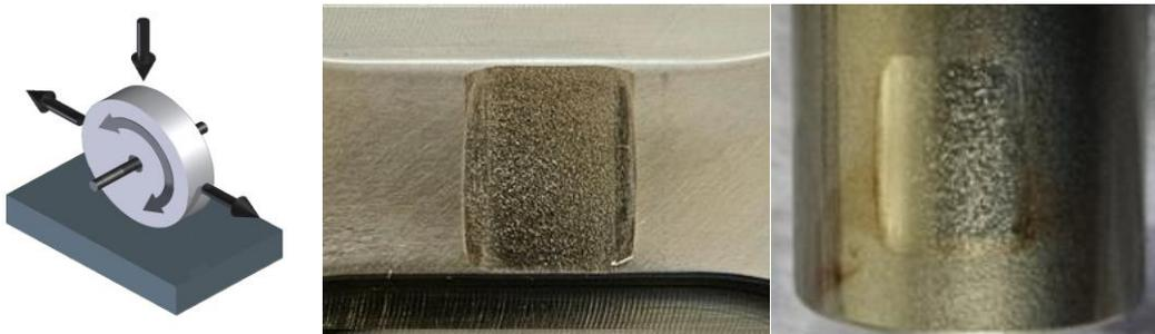
An den Hubenden, wo das Gleit-Roll-Verhältnis maximal ist, fällt die Gleitgeschwindigkeit auf Null und Mikropitting führt zu plastischer Verformung und Gleitverschleiß.
