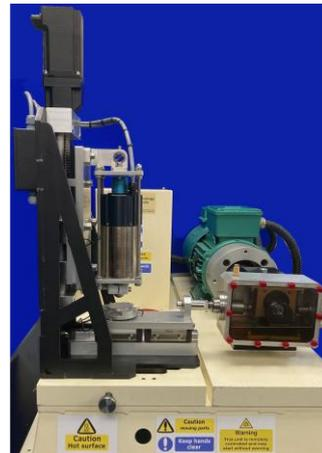
Der Adapter erzeugt den normalen Aufprall einer Kugel auf eine hin- und hergehende Plattenprobe mit vollständig synchronisierter vertikaler und horizontaler Bewegung.
